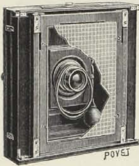
Chambre repliée montrant l'obturateur et l'objectif à l'intérieur de la chambre.
